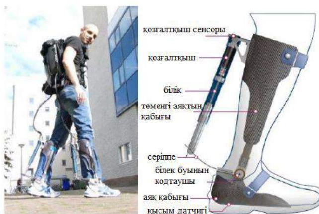
Сурет 1.13 Ахилл экзоскелетінің суреті (сол жақта) және экзоскелет компоненттерінің сипаттамасы (оң жақта) [45]
