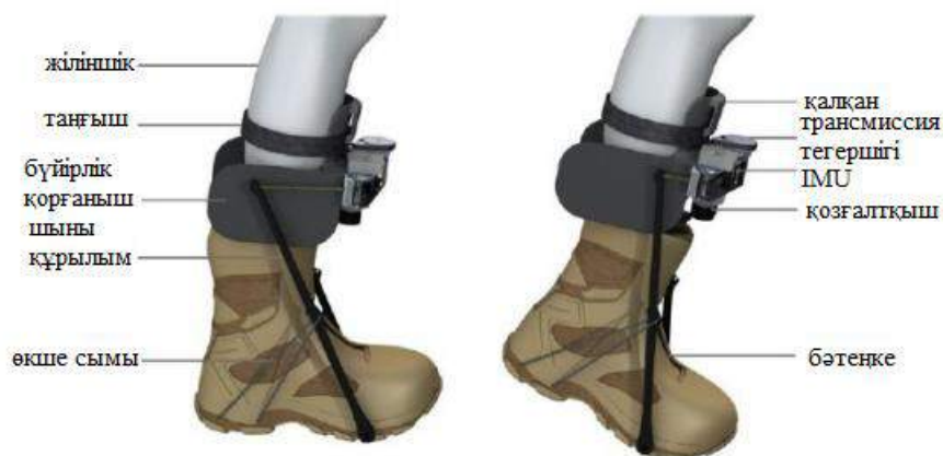
Сурет 1.12 Массачусетс технологиялық институтының автономды экзоскелеті [43]
